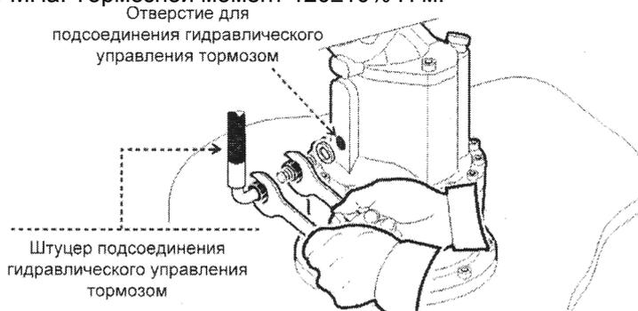
**Рис. 5. Присоединение управляющего трубопровода тормоза к мотор-редуктор**
