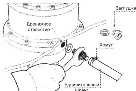
**Рис.6. Схема монтажа удлинительного шланга к сливному отверстию.**
